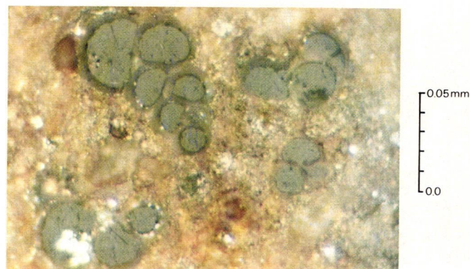
Fotografía 11. Muestra 9 - Obj. 40x, luz incidente, aceite de inmersión. Caliza típica de la parte inferior de la formación con caparzones de foraminíferos rellenos de bitumen. La caliza es micrítica con algunos cristales de pirita altamente reflectantes.
